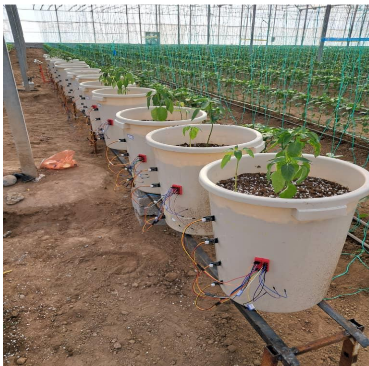
شکل ۲- نحوه نصب سنسورها در عمق‌های متفاوت در لایسمترها
